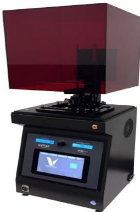
Fig. 4 - Impresora con tecnología DLP para fabricación de los moldes auditivos.
